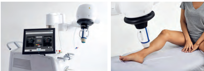
Slike 17, 18. SONOVEIN – robotska ruka ultrazvučnog uređaja u direktnom je kontaktu s kožom i kompjuterski navođeno ciljano zatvarana venu u dubini fokusiranim UZV snopom
